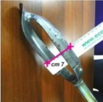
Inserire un righello centimetrato all'interno della trivella (nell'area centrale). Fissare lo zero in corrispondenza del bordo esterno di una lama e leggere la misura sul bordo esterno dell'altra lama. Il valore corrisponde al diametro della carota/campione prelevata.
