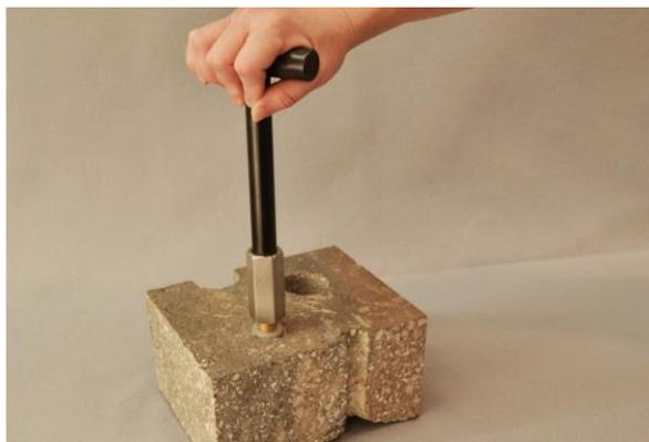
Fig 7. Rimozione del Vapor Pin™.
