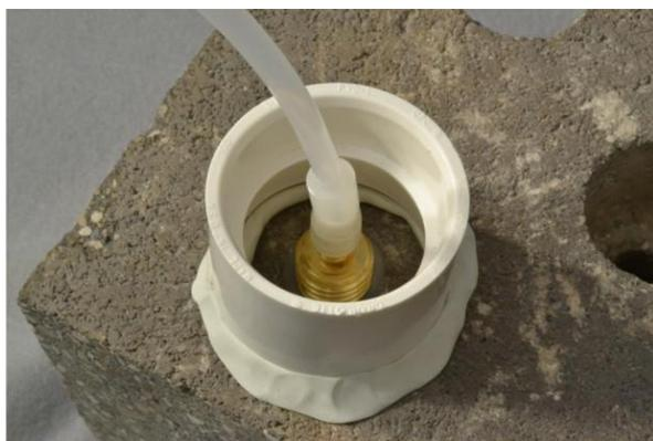
Fig 6. Collettore d'acqua per test di tenuta
