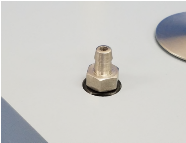
Figure 6. Mini Vapor Pin® Installation Complete
