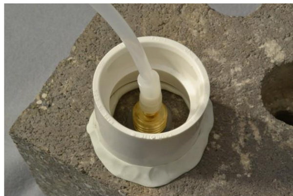
Figura 6. Tubo di contenimento
